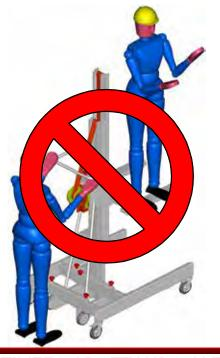
DI INDURRE OSCILLAZIONI SUL SOLLEVATORE DURANTE LE OPERAZIONI DI SALITA / DISCESA DEL CARICO
