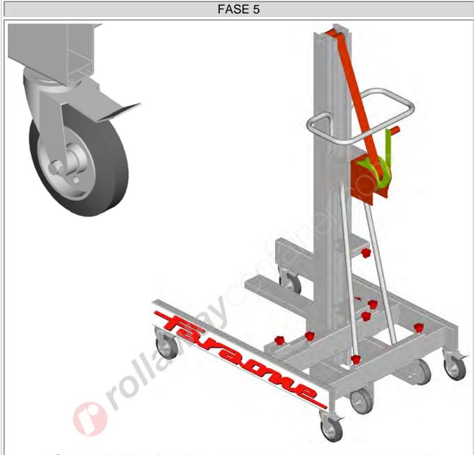
INSERIRE TUTTI E QUATTRO I FRENI IN DOTAZIONE ALLE RUOTE PIVOTTANTI.
