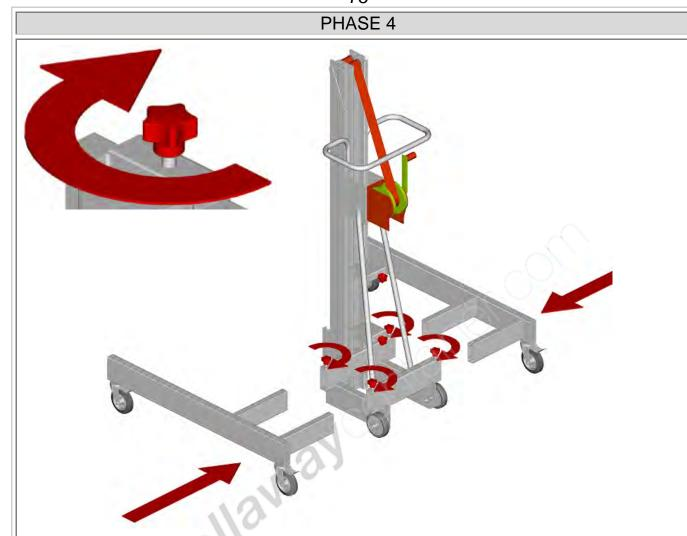
SET UP THE TWO STABILIZERS ON THE RIGHT HOUSINGS OF THE BASE (FRAME).
